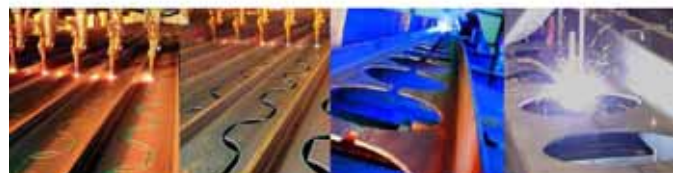
Fabricación de vigas alveolares Fuente: ArcelorMittal: Innovative Solution in Composite Structures
